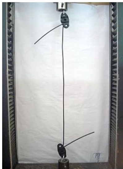
FOTO ILUSTRATIVA ENSAIO DE CAPACIDADE DE AGARRAMENTO
